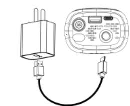
Entrée de chargement Type-C 5V/2A. Connectez le câble de chargement à la pompe et à l'adaptateur secteur (que vous devez acheter séparément) pour charger la pompe. Barre d'indication de puissance en état de chargement : Barre d'indication clignotante : en cours de chargement. Lorsque la barre d'indication est allumée en continu : la charge est complète. Conseils : N'utilisez pas la pompe pendant le chargement.
